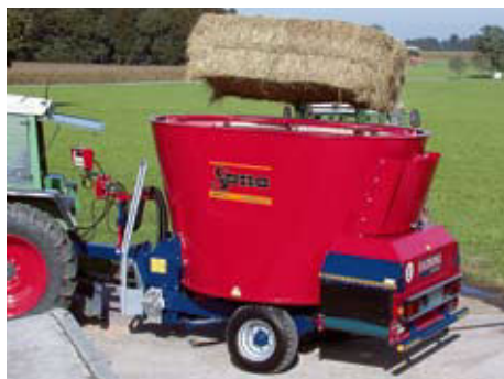
Opcija: Poprečna traka nazad za obostrano izbacivanje hrane, npr. pojedinačne hranilice, bez kotrljanja hrane.
