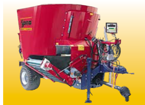
Opcija: Preklopna dodatna traka u različitim dužinama, za posluživanje na većim visinama. Ovde u kombinaciji sa uskom poprečnom trakom (preklopljen bez povećavanja spoljne širine).
